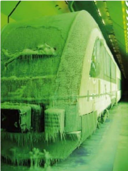
Schienefahrzeug unter extremen Klimabedingungen im Klimawindkanal (Foto: RTA)
