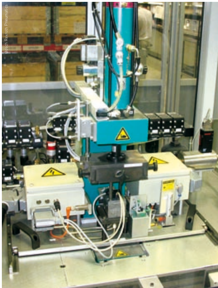
Jeder Prüfstand verfügt über einen umfangreichen pneumatischen Aufbau mit Spannvorrichtung für den Prüfling.
