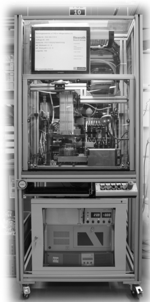
Bild 1: a-uni im Einsatz. Dieser Prüfstand für elektropneumatische Automotive-Komponenten basiert auf dem Universalprüfstandskonzept des Autors.
